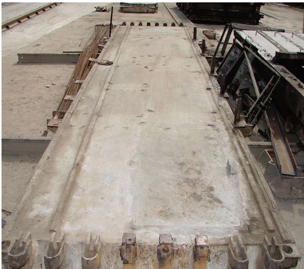
Рисунок 2 – Опалубочна форма для пустотних залізобетонних панелей Figure 2 – Formwork for hollow reinforced concrete panels
